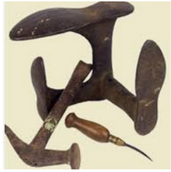
Attrezzi da calzolaio: la forma; la lesina; il martello
