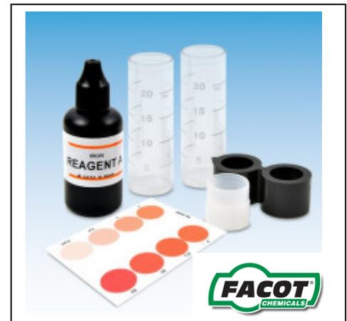
La quantità di Ferro, max consentita nelle acque è di 0,2 mg/L. In un'acqua stagnante già con un contenuto di 0,1mg/L, i «batteri del ferro» creano una melma bruno-rossastra che può ostruire le tubature e causare un odore sgradevole.
