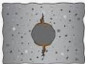
INNESCO DELLA CORROSIONE
