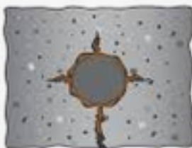
FESSURAZIONI E MACCHIE SUPERFICIALI
