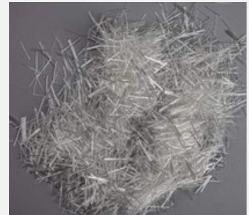
Fibre in polimero plastico L=20..30 mm; dosaggio 1,5..5 kg/m 3 impasto
