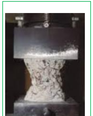
prova di rottura su cubetto di calcestruzzo alla compressione
